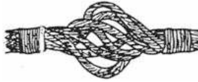
Figura 32 – defeito “gaiola de passarinho”
