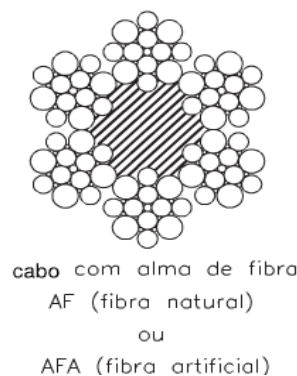
Figura 8 – Alma do cabo de aço
