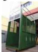
Figura 51– Cabina do elevador de passageiros
