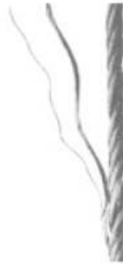
Figura 13 – Pernas do cabo de aço
