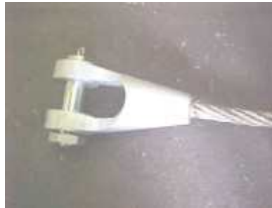
Figura 26 – Corrosão na base dos soquetes.
