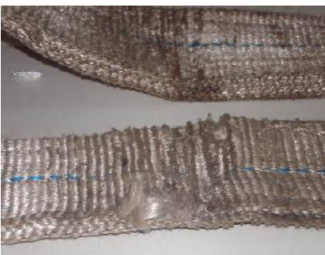
Dano por aquecimento
