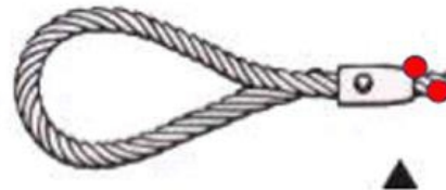
2 ARAMES ROMPIDOS NA BASE INFERIOR DA PRESILHA CLASSE 6X37
