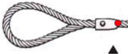
1 ARAME ROMPIDO NA BASE INFERIOR DA PRESILHA CLASSE 6X19
