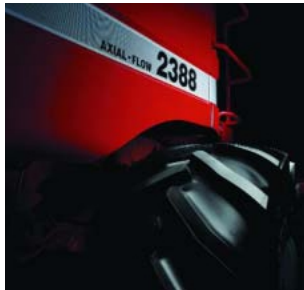
Pneu de alta flutuação, reduz a compactação do solo.
