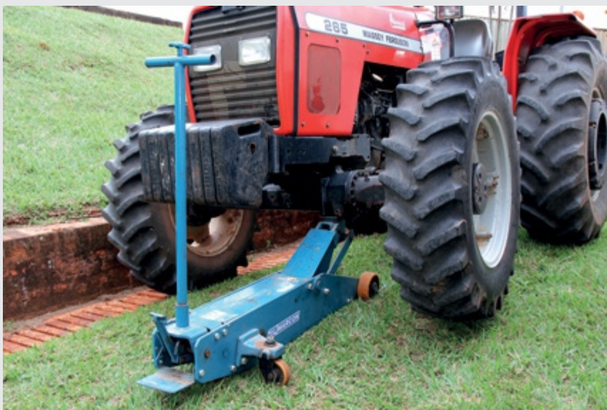
Figura 193 – Lastragem líquida: levantando a roda.
