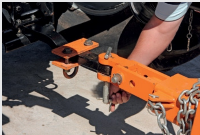
Figura 08 – Colocação do contra pino.
