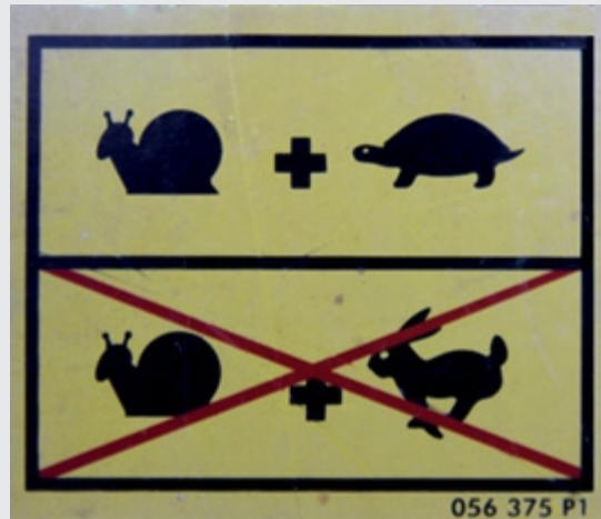
Figura 85 – Utilização do super-reductor no grupo de baixa velocidade.
