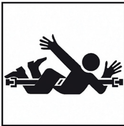
Figura 07 – Pictograma da descrição do risco com o eixo cardam.
