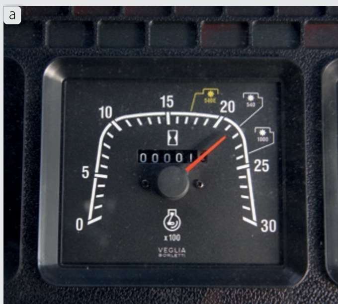
Figura 95 – Rotação no motor correspondente a 540 rpm na TDP: (a) No tacômetro. (b) No adesivo na cabine.
