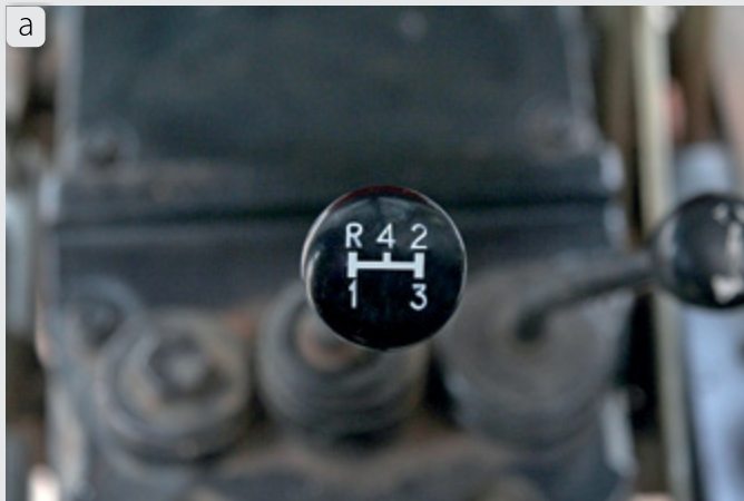
Figura 79 – Alavanca de marcha: (a) Com a marcha à ré. (b) Sem a marcha à ré.
