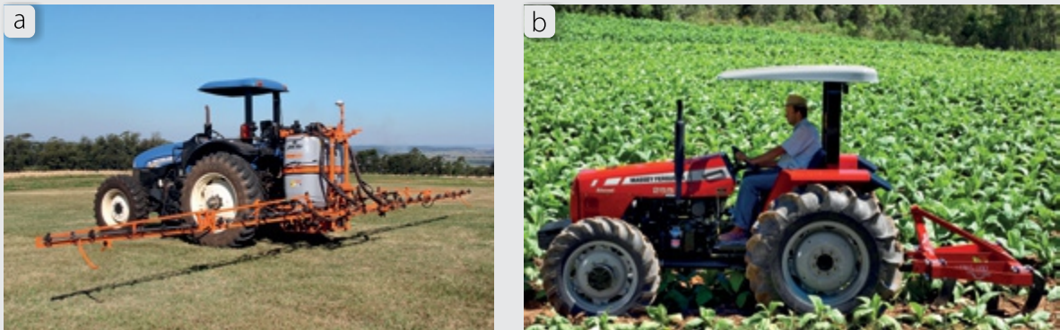
Figura 40 – Implemento de três pontos: (a) de superfície. (b) de penetração.
