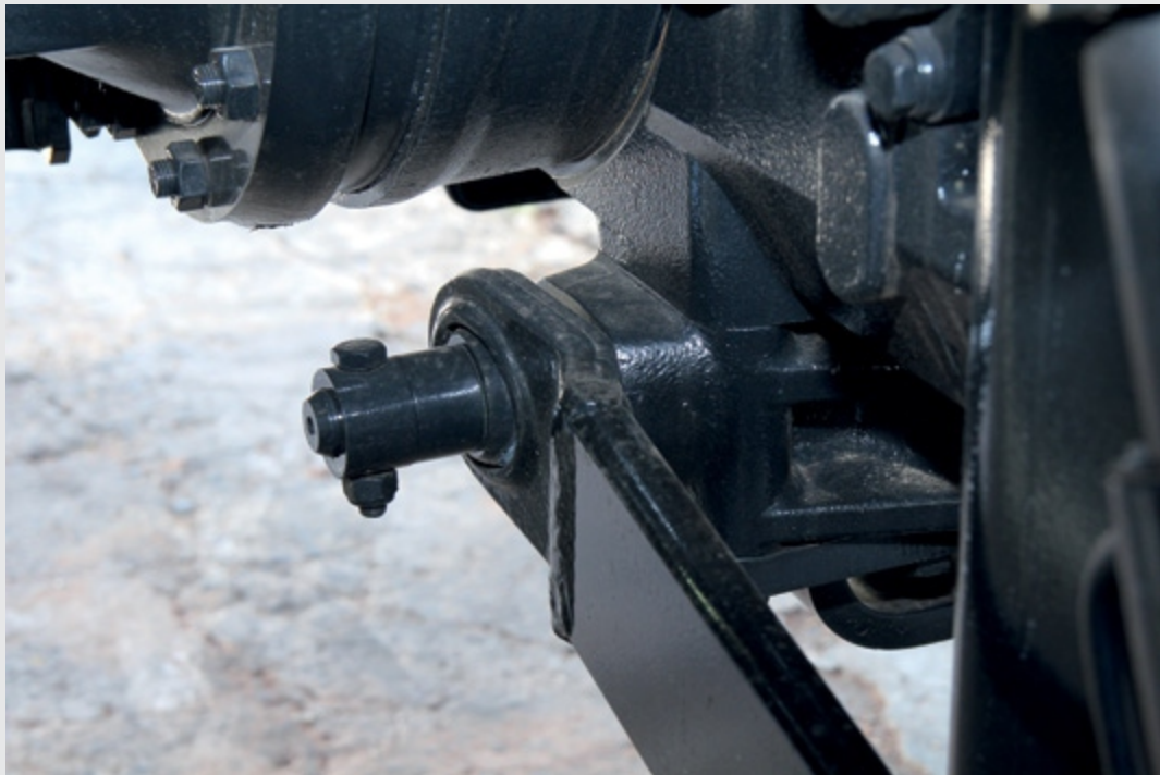
Figura 115 – Controle de sensibilidade: sensor no pino de flexão das barras ineriores de acoplamento.
