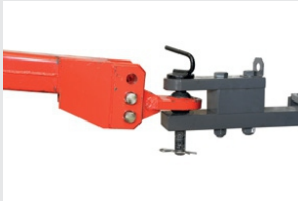
Figura 171 – Pino passando por três furos.
