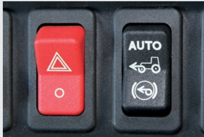
Figura 73 – Acionamento automático da tração dianteira.
