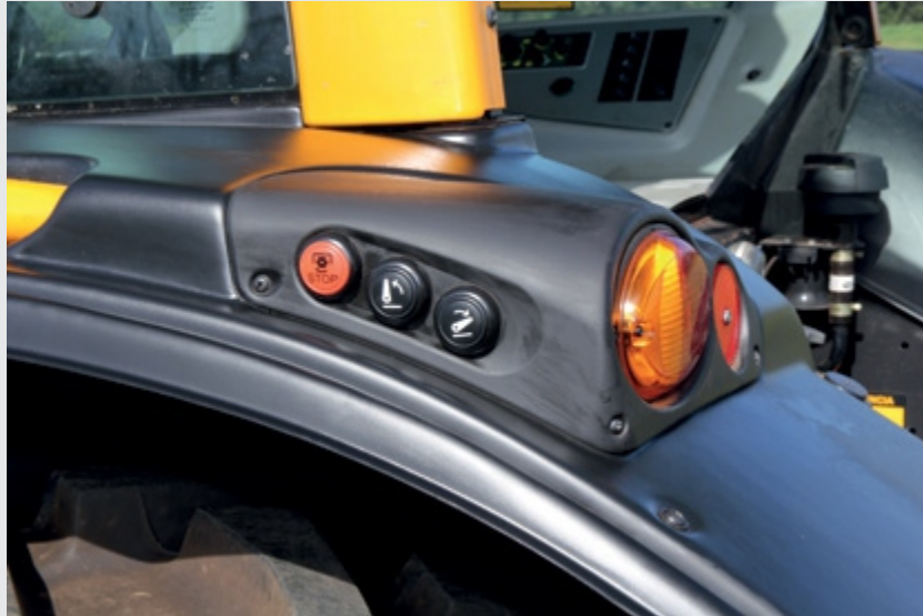
Figura 142 – Interruptor externo para acionamento do sistema hidráulico.
