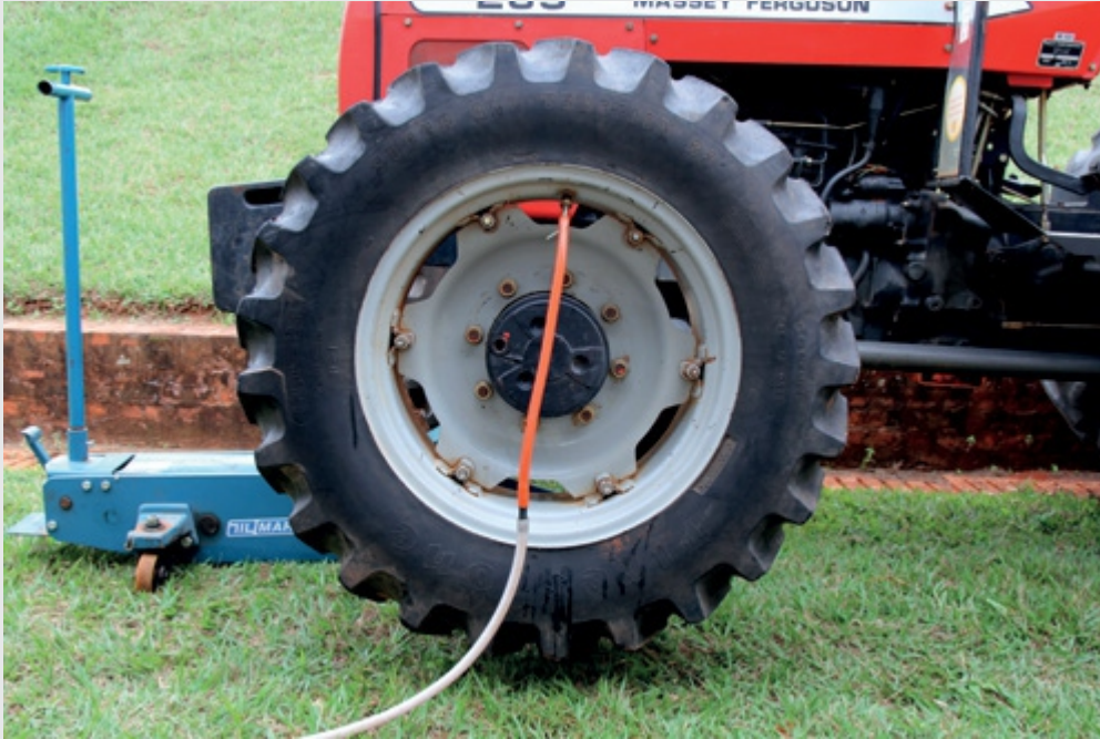
Figura 196 – Lastragem líquida: colocando água no pneu.
