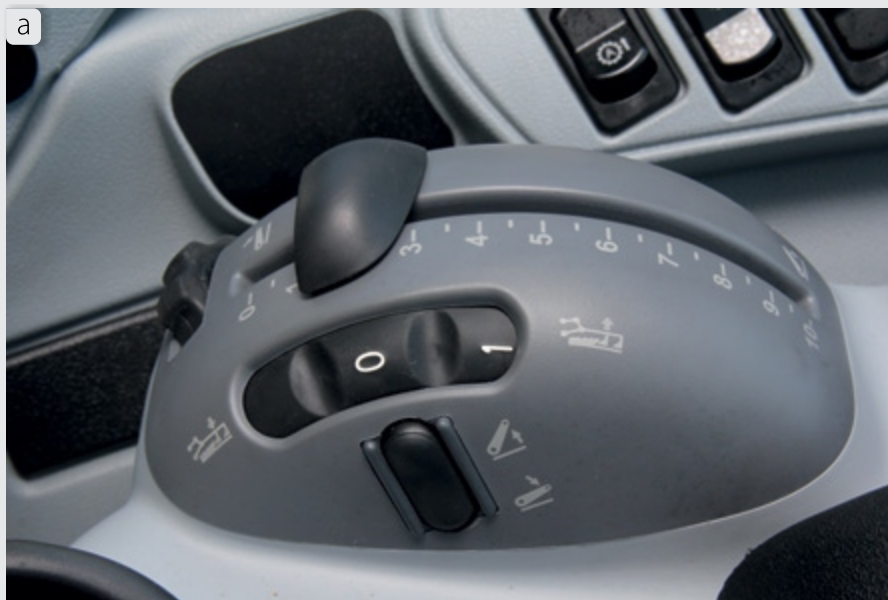
Figura 110 – Sistema hidráulico de três pontos: a) Controle de profundidade. (b) Implemento de penetração.
