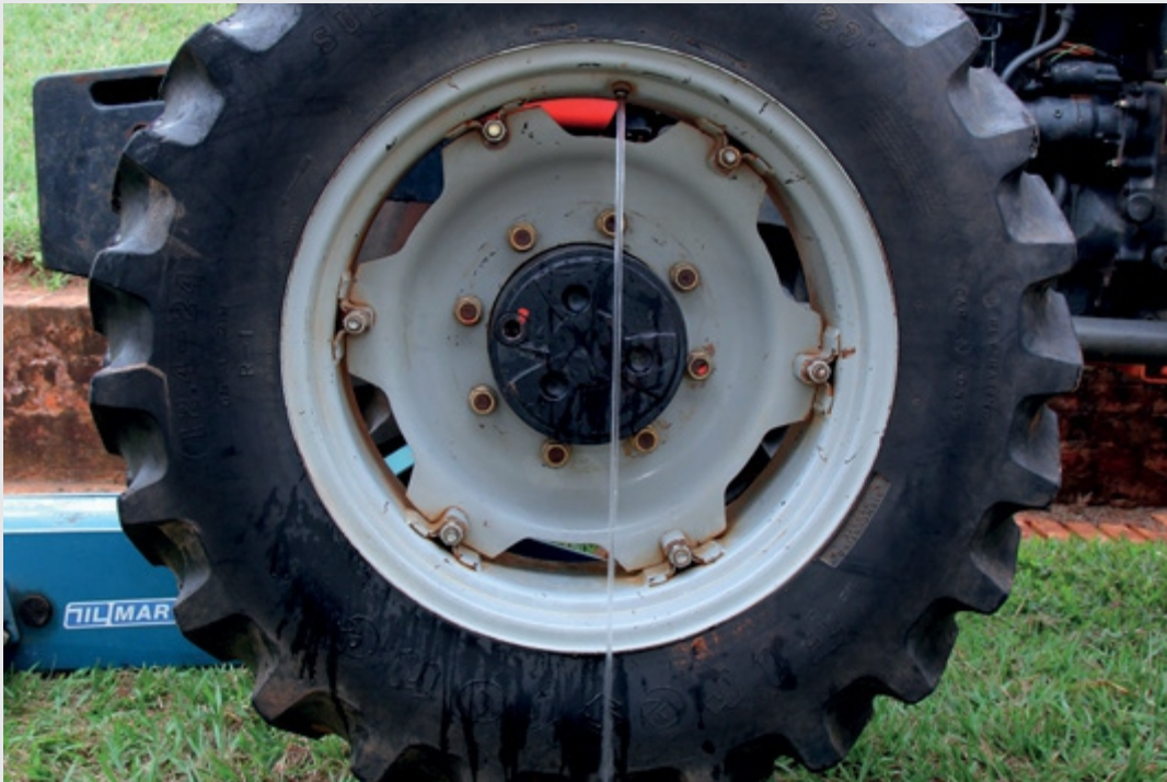
Figura 198 – Lastragem líquida: saída do excesso de água.
