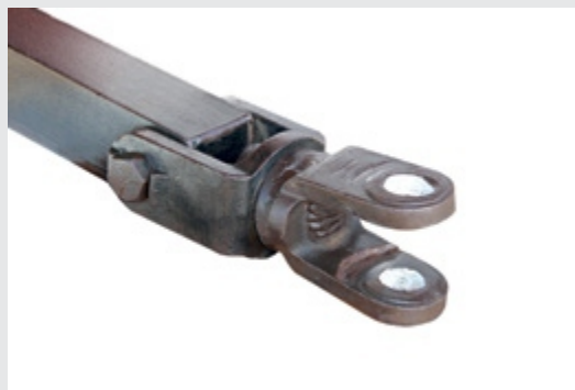
Figura 162 – Cabeçalho com boca de lobo giratória e basculante.
