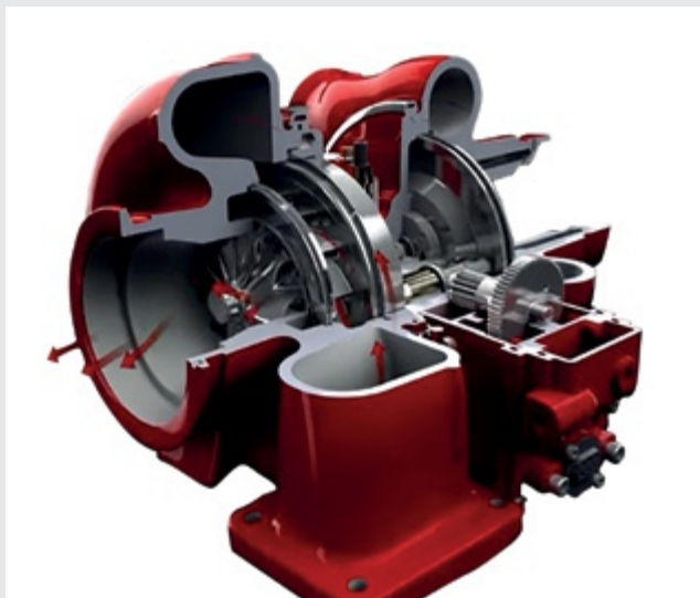
Figura 25 – Turbo compressor com geometria variável.
