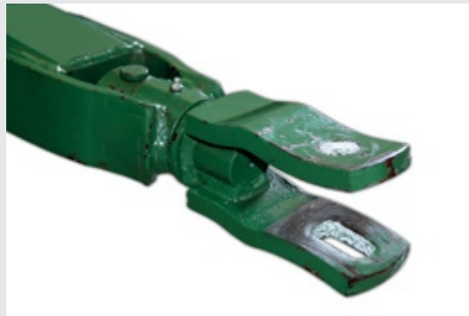
Figura 161 – Cabeçalho com boca de lobo giratória e um dos furos oblongo.
