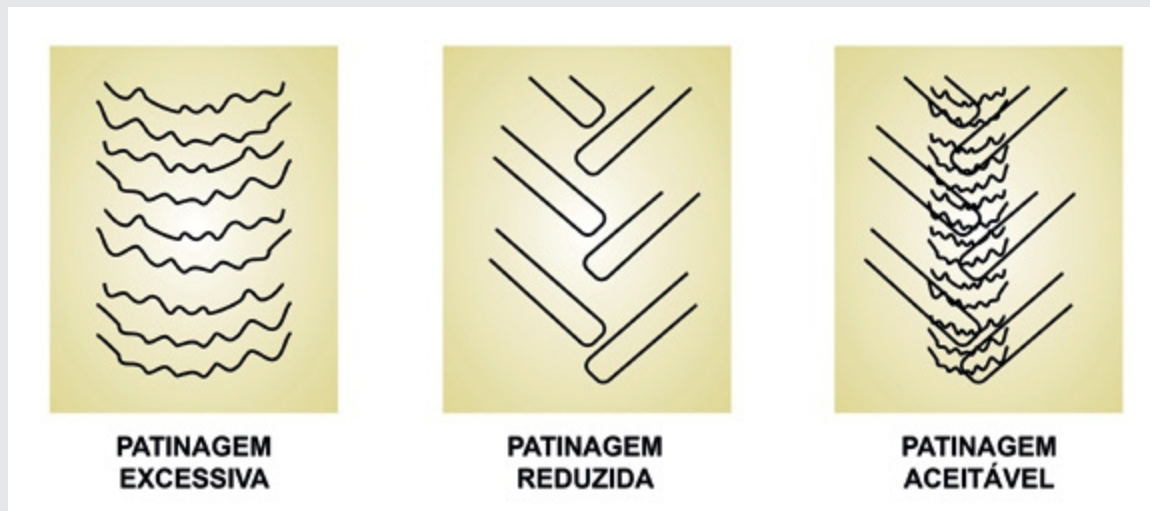
Figura 218 – Observação da patinagem pelo rastro do trator.
