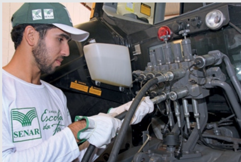
Figura 121 – Acoplamento hidráulico entre o trator e o implemento.
