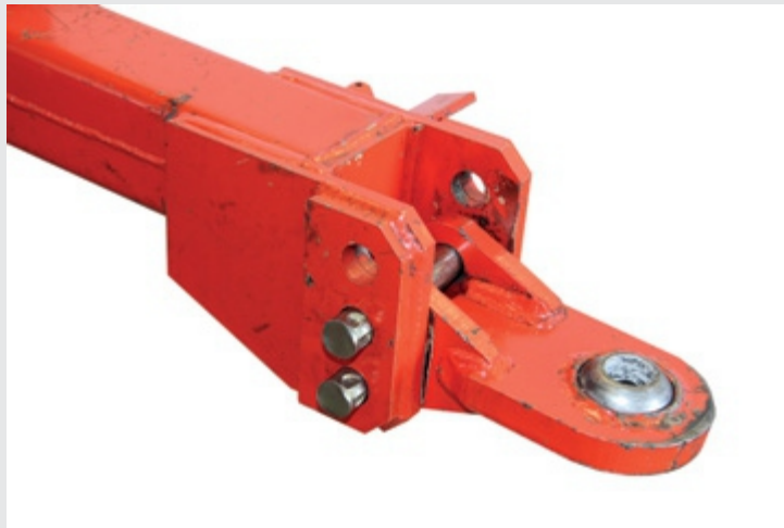
Figura 164 – Cabeçalho com rótula não giratório e não basculante.
