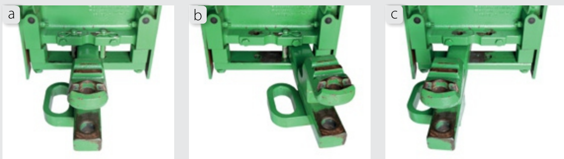
Figura 159 – Posições da barra de tração na bandeja: (a) fixa no entreo. (b) fixa na leral. (c) oscilante.
