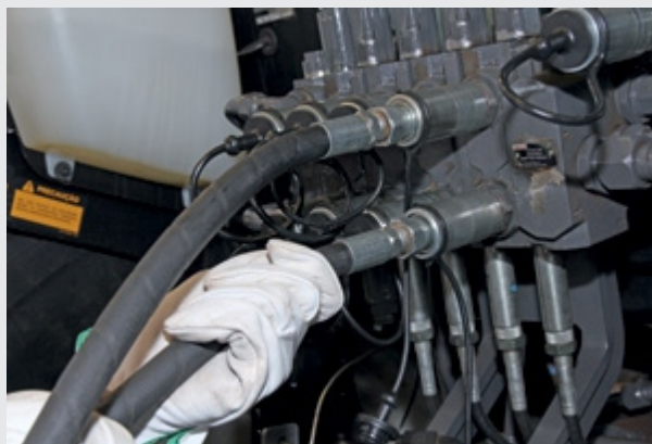
Figura 135 – Sistema hidráulico de controle remoto – engate rápido do tipo macho e fêmea.
