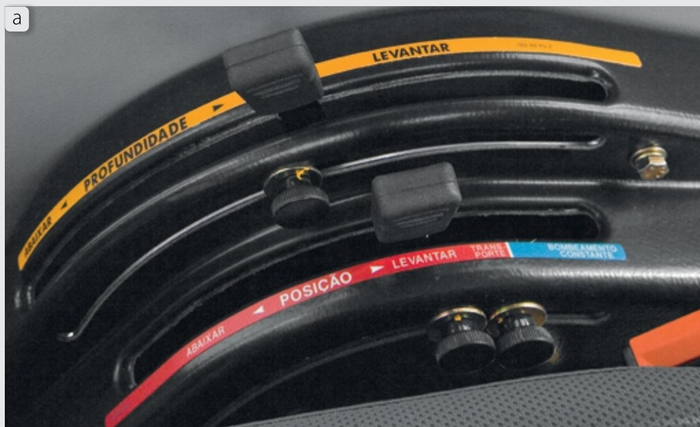
Figura 109 – Sistema hidráulico de três pontos: (a) Controle de posição. (b) Implemento de superfície.
