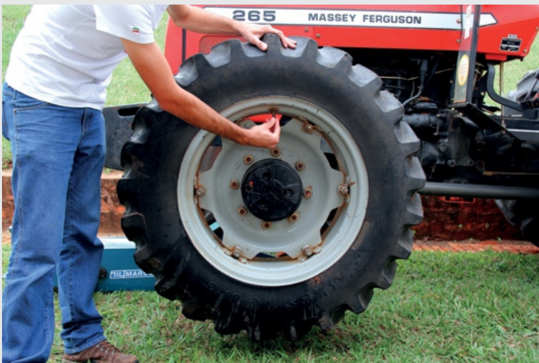
Figura 199 – Lastragem líquida: recolocando a válvula.
